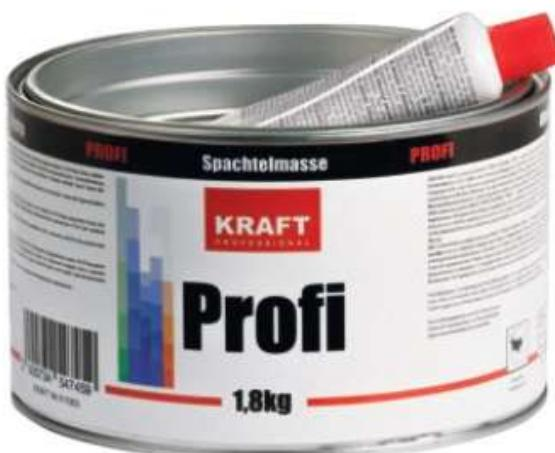
Универсальная полиэфирная шпатлевка. Имеет хорошую заполняющую способность, обладает отличной адгезией, легко наносится, образует гладкую поверхность, быстро сохнет. Отлично шлифуется, не забивая наждачную бумагу. Может применяться на стальных, алюминиевых, оцинкованных поверхностях, а так же на дереве, стеклопластике и бетоне. После отвердевания шпатлевка становится стойкой к воздействию кислот, щелочей, растворителей и соляной кислоты невысокой концентрации.
